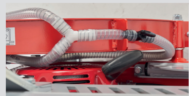
Doppio imbocco acqua per un migliore raffreddamento del disco
