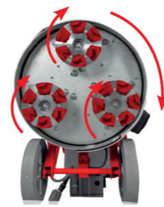
Da 9 a 18 moduli con piatti satellitari che possono ruotare singolarmente o solidali al piatto
